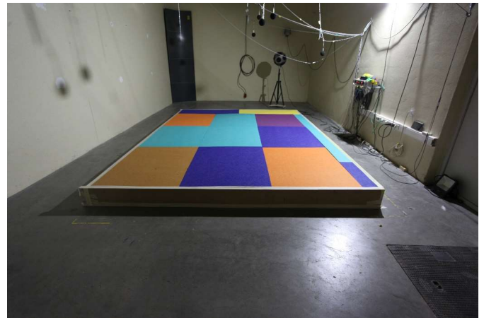
photo : mise un place du test SlimPanel 9mm avec une espace d'air de 191mm Type montage E-200
