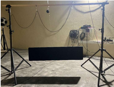
Photo : échantillon monté dans la salle réverbérante
