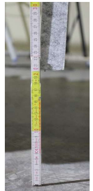
Photo : détail de la hauteur de suspension de 200 mm dans les test 12 et 13
