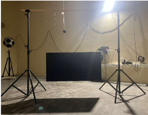
Photo : échantillon monté dans la salle réverbérante
