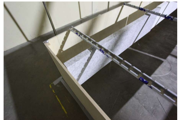
photo : détail du montage de la SlimBox Baffle lors de la mise en place de l'essai
