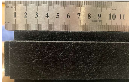
Photo : vue en coupe, Slimbox baffle
