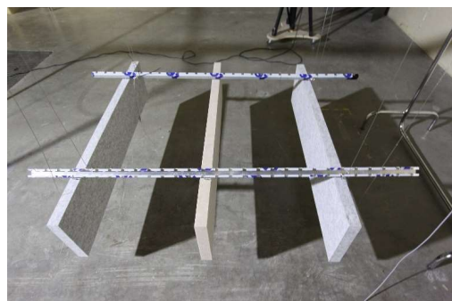
Photo l'essai 13 : un objet = 1 grille avec 3 Slimbox Baffles suspendus à des rails en U avec un espacement de 500 mm entre les centres (points de suspension) des baffles
