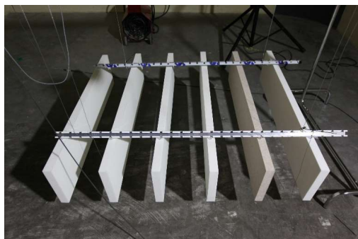
Photo l'essai 12 : un objet = 1 grille avec 6 Slimbox Baffles suspendus à des rails en U avec un espacement de 250 mm entre les centres (points de suspension) des baffles
