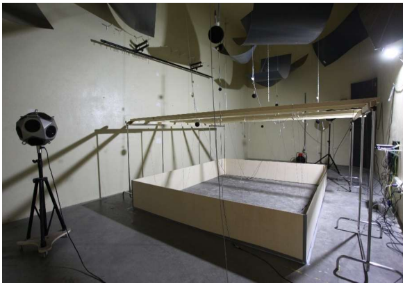
photo : Chambre réverbérante vide avec cadre non absorbant pour la mise en place des mesure
