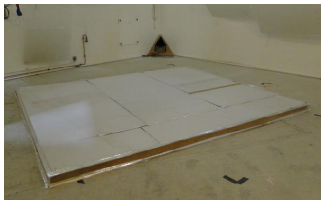
Essai 6 : Cloison avec RENOSOUND 20
