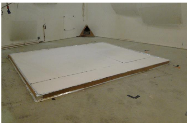
Test 7 : Partition with RENOSOUND 10 peint
