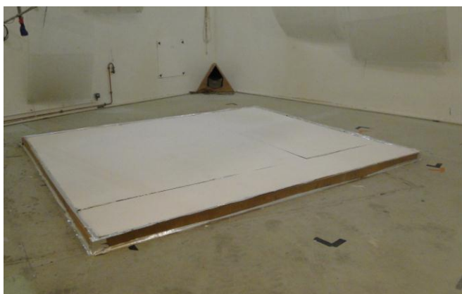
Prueba 5 : Tabique con RENOSOUND 10
