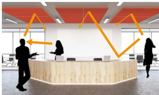
Fig. B. Con una corrección acústica, los paneles o los revestimientos acústicos absorben parte de los sonidos, mejorando así el confort acústico del espacio.
